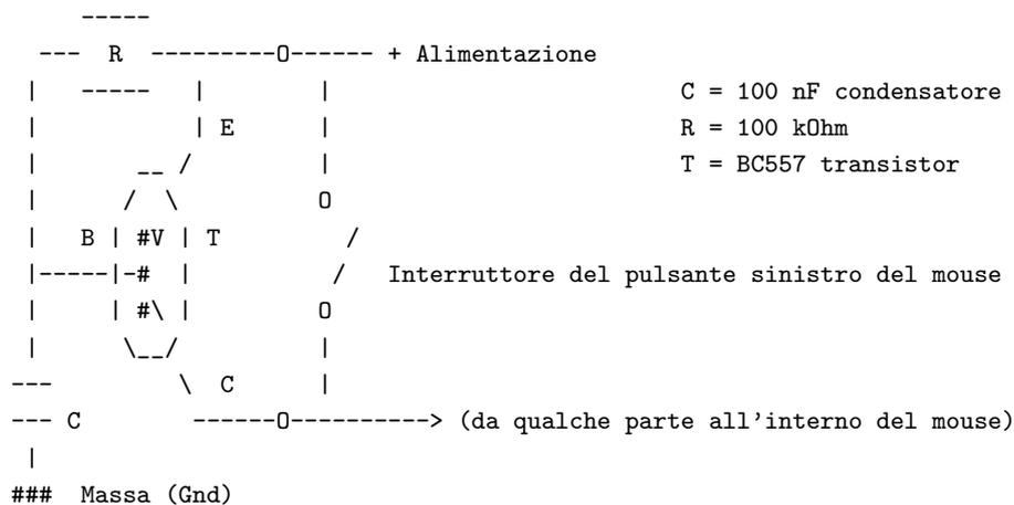
Il mouse su cui è stato provato è un MUS2S senza marca - se ciò funziona anche per altri mouse dipende dal circuito del mouse in causa. Se l'interruttore è collegato a massa invece che all'alimentazione positiva, allora dovrebbe andar bene un transistor npn come il BC547; in tal caso vanno scambiate anche R e C.
